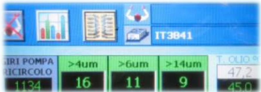
I sistemi filtranti **Parker** gestiscono la cattura delle particelle inquinanti presenti nel serbatoio macchina e il lettore tiene aggiornati in tempo reale sulla classe rilevata.
